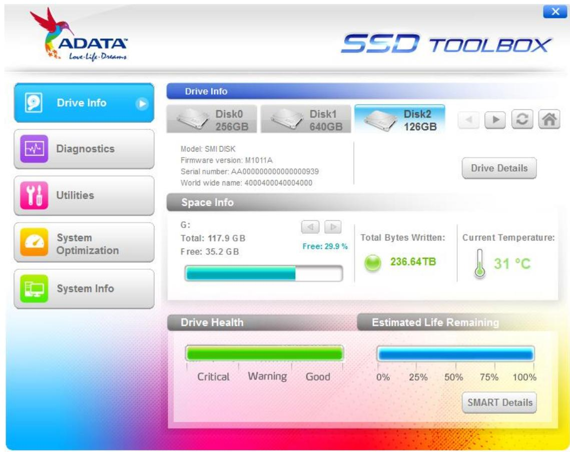
Disk Drive，顯示目前所有連接的硬碟(包含非 ADATA 固態硬碟產品)。選定硬碟顯示的資訊包含硬碟總容量、已使用容量、硬碟工作溫度、硬碟健康程度以及硬碟壽命。
